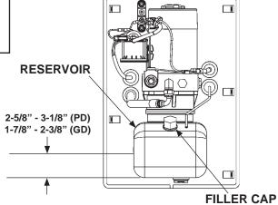
PUMP RESERVOIR (GRAVITY DOWN POWER UNIT SHOWN) FIG. 42-1
