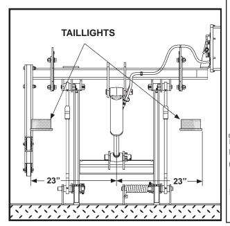
TAILLIGHT HORIZONTAL SPACING, TOP VIEW FIG. 56-3
