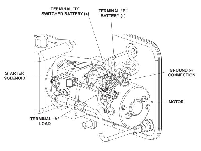
12 VDC POWER UNIT (GRAVITY DOWN SHOWN) FIG. 38-1
